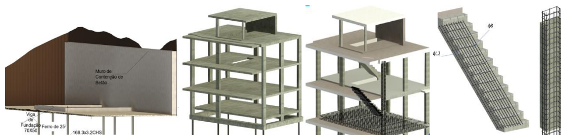
Figura 4. Representação de elementos de fundação e pilares e a pormenorização de armaduras em elementos estruturais.
